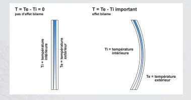
L'effet bilame est la répercussion d'une différence de dilatation des composants intérieurs et extérieurs de la menuiserie. Le profilé extérieur monte en température et s'allonge pendant que le profilé intérieur reste à température ambiante.
